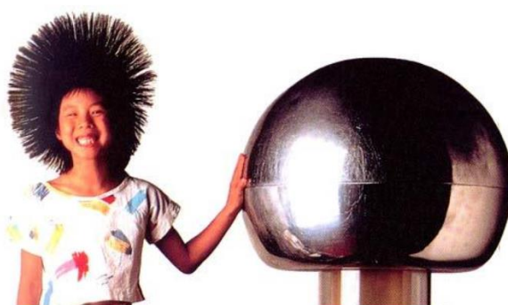
ภาพที่ 8 แสดงการทำงานของเครื่องกำเนิดไฟฟ้าสถิต (Van de graaff generator)
